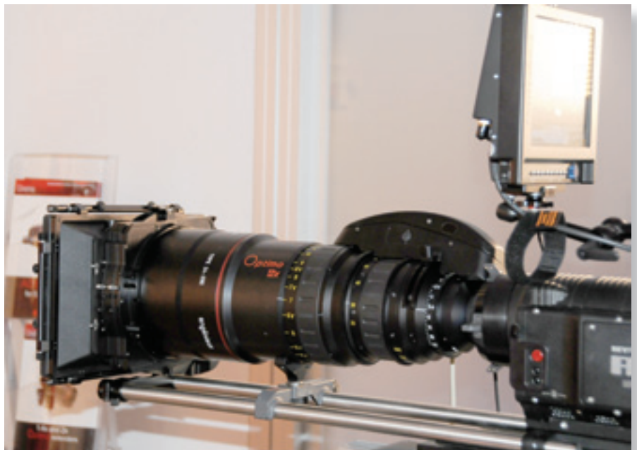
12-кратный объектив Optimo 24-290 с установленным на нем блоком/i
